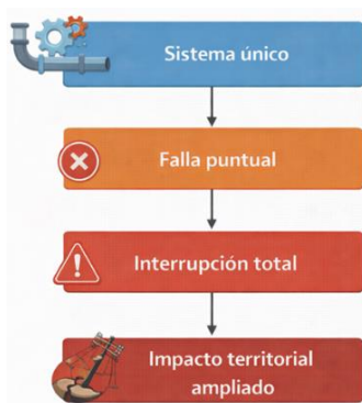
Figura 1-8. Esquema de riesgo por ausencia de redundancia
