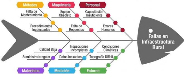
Figura 4-8. Esquema del análisis de causas raíz aplicado a infraestructura rural
