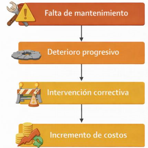
Figura 1-6. Ciclo de deterioro por mantenimiento reactivo
