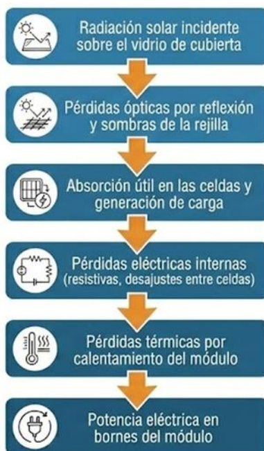
Figura 3-1. Esquema conceptual de flujo de energía y fuentes de pérdidas en un módulo fotovoltaico. El diagrama se basa en modelos de flujo de energía y análisis CTM como los utilizados en las evaluaciones de Fraunhofer ISE y en guías de diseño de IRENA para plantas fotovoltaicas a gran escala.
