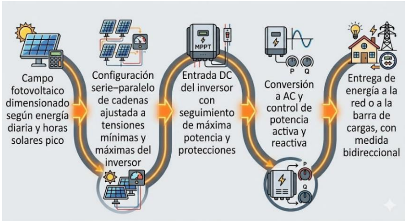
Figura 3-3. Esquema conceptual de interacción entre campo fotovoltaico e inversor en un sistema conectado a red
